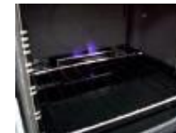
Four gaz à chauffe directe
